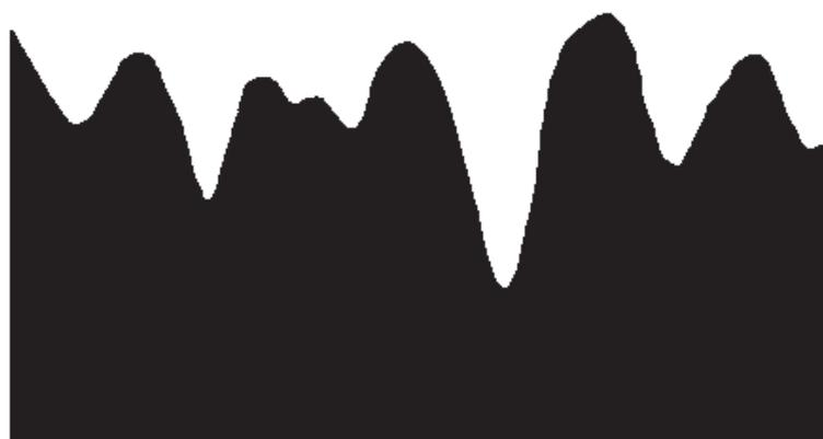
Abb. 3: Scharfe Schwärzungsbegrenzung nach mehrmaligem Umkopieren von Abb. 2 auf extrahartes Photomaterial
