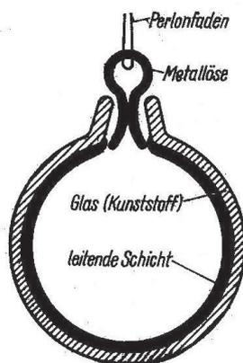
Bild 1 Schnitt durch eine Weihnachtsbaumkugel mit elektrisch leitender Innenschicht
